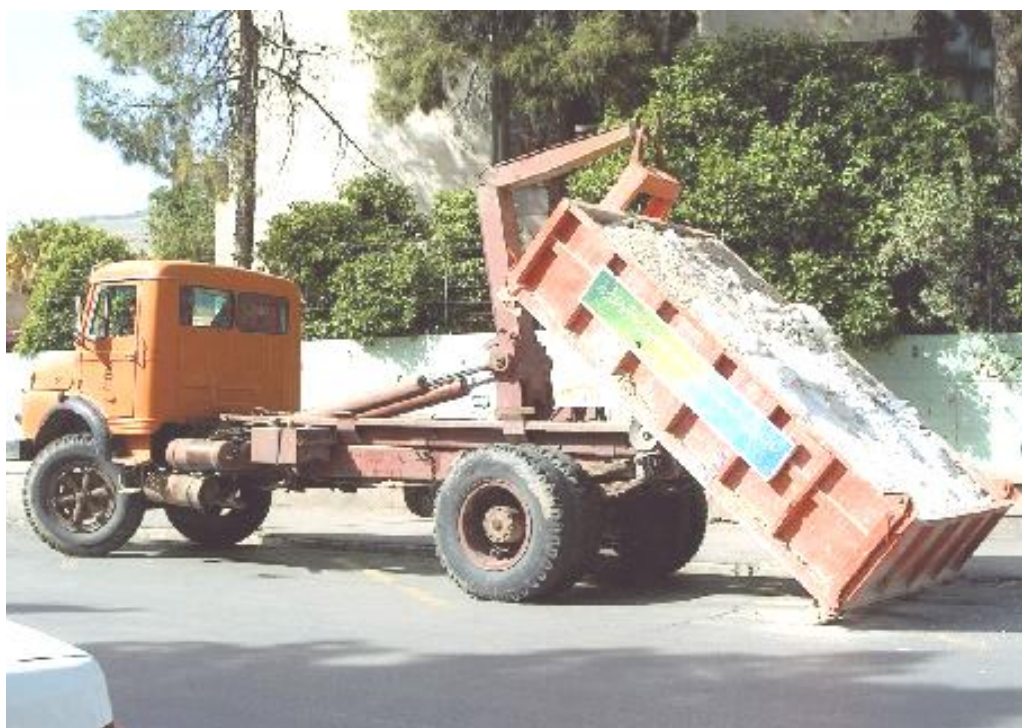
شکل ۶- نحوه تخلیه، بارگیری و انتقال مخازن ذخیره بزرگ به ایستگاههای انتقال در ایران
